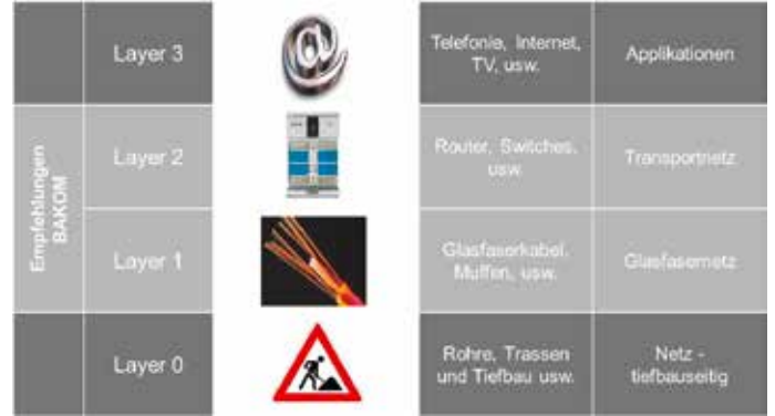
Layermodell für Glasfaserinfrastrukturen
